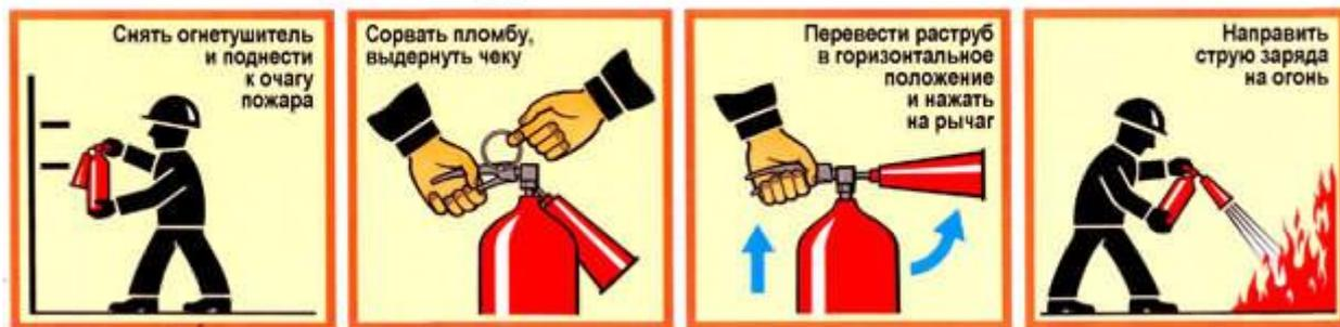
При работе огнетушителя направлять раструб в нужную сторону и удерживать его необходимо только при помощи рукоятки, специально смонтированной на подвижной трубке. Если такой ручки нет, то подводящие трубки должны иметь пластмассовые покрытия. Ни в коем случае нельзя держать раструб углекислотного огнетушителя незащищенной, голой рукой – углекислотный снег имеет очень низкую температуру и это может стать причиной сильного обморожения рук.
